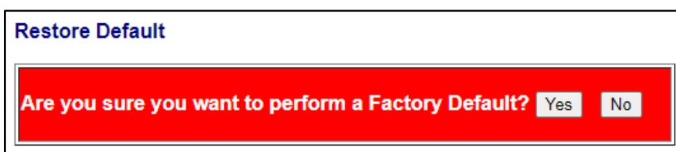
電源装置のIP設定を除く、すべての設定を工場出荷時の設定値に戻します。
